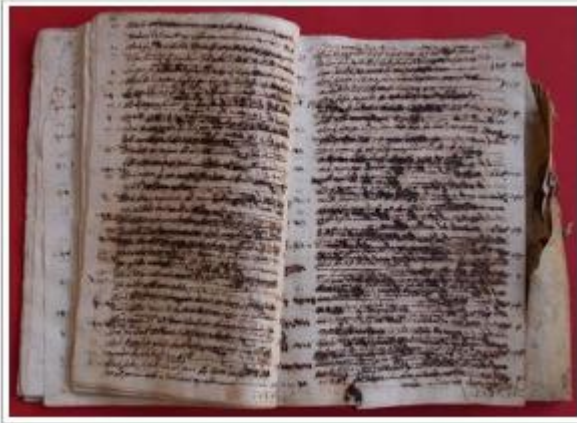
5 Corrosión del papel causada por las tintas. Foto ©MDM
