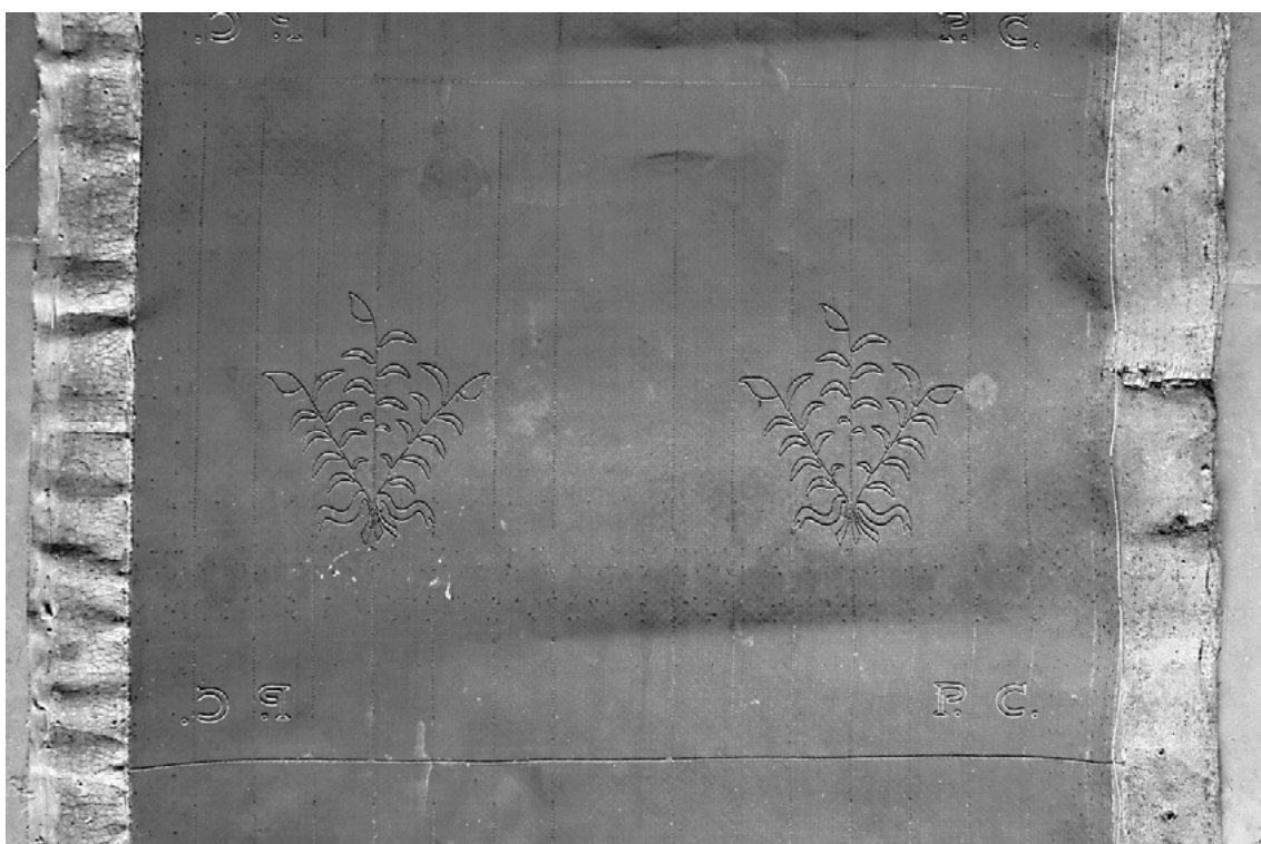
Fotografia 7. Teia com filigrana: ramo de oliveira e letras “P. C.”, alusivas a Porto de Cavaleiros. L 59 cm X C 273 cm. Fábrica de Papel de Porto de Cavaleiros.
