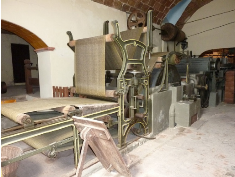
Figura 6 Máquina sistema Piccardo en la fábrica Munné de Capellades. Mantuvo su actividad hasta el año 1974.
