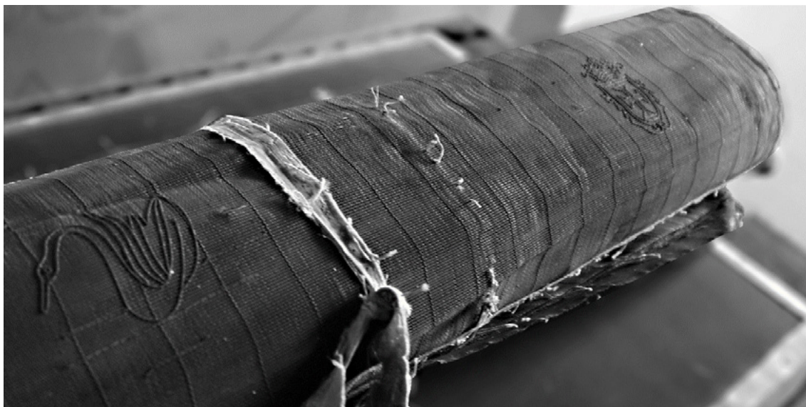
Fotografia 2. Teia filigranada para papel de carta e envelope, representando um cisne e um escudo. L 60 cm X C 367 cm. Máquina de fôrma redonda da Fábrica de Papel de Porto de Cavaleiros.
