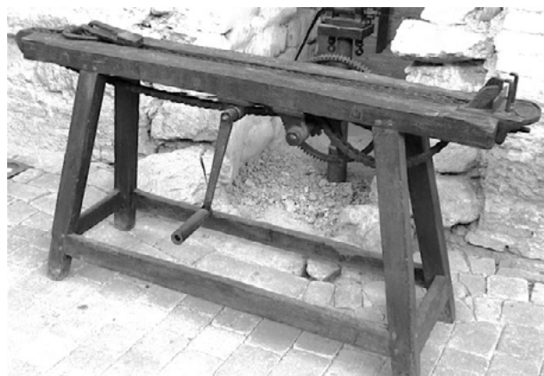
Fig. 4 Antigo banco manual para estirar hilo metálico, siglo XIX. Fig. 5 Filigrana del Hospital General de Pamplona. Archivo Histórico de la provincia de Buenos Aires. La Plata (Argentina). Foto: JCB.
