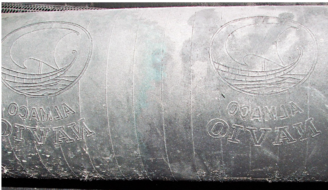
Fotografia 18. Rolo filigranador “Almaço Navio”. Antiga fábrica “Graham. Indústria de Papel da Abelheira”. Acervo da Fapajal – Fábrica de Papel do Tojal, S. A..
